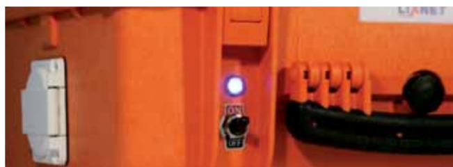
Wasserdichter Hauptschalter mit Kontrollleuchte im geschützten Bereich des Koffers / Commutateur central étanche avec voyant de contrôle dans la zone protégée de la valise.
